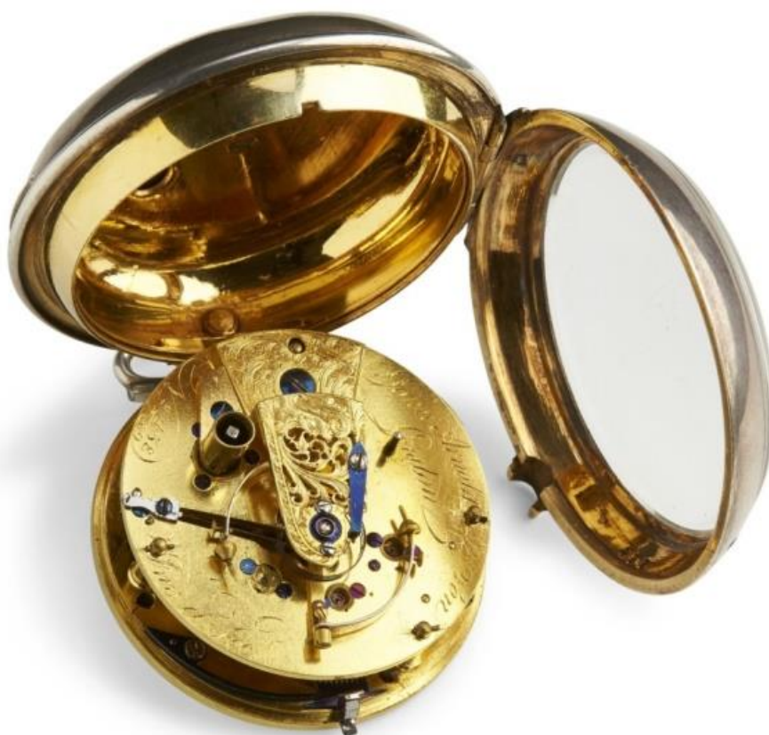
Fig. 12. John Arnold lommekronometer nr. 438/739. Bemærk Z-balancen.
